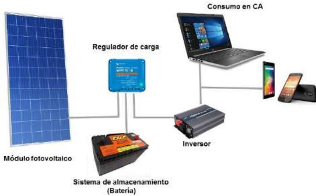
Figura 5. Componentes del módulo sustentable.
