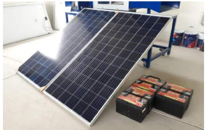
**Figura 11.** Módulos fotovoltaicos EGE-330P-72 y Baterías solares CALE 115 Ah. Laboratorio de Energías Renovables ITESHU.
