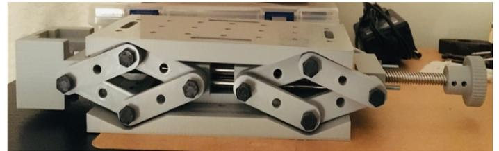
Imagen 4.- Plataforma de elevación, fabricada en impresión 3D.
