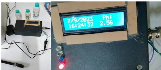
**Figura 1.** Calibración con los buffers y medición de pH.
