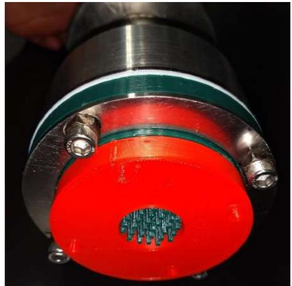
Figura 8. Cabezal y matriz de la extrusora.
