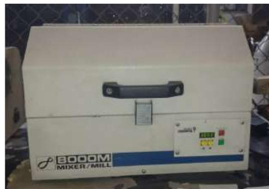
Figura 2. Molino de bolas de alta velocidad.
