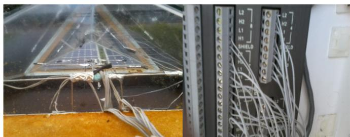
**Figura 4.** Instrumentación del destilador solar y conexiones de sensores al adquisidor de datos.
