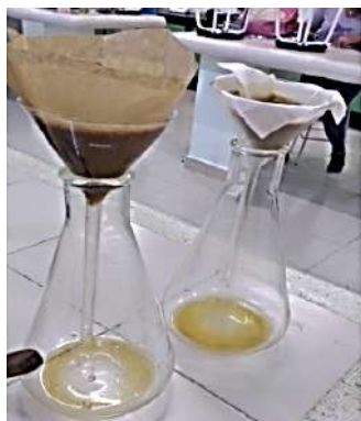
Figura 1. Proceso de filtración del aceite de fritura usado (elaboración propia).
