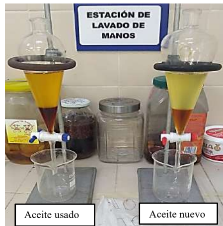
Figura 2. Fases de la decantación del aceite usado y aceite nuevo (elaboración propia).
