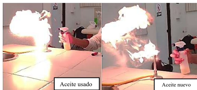
Figura 3. Pruebas de flamabilidad del aceite vegetal usado y aceite vegetal nuevo (elaboración propia).
