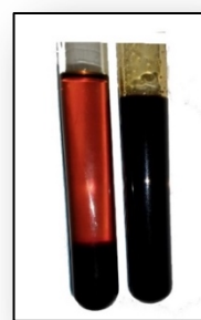
Figura 2. Biodiesel con glicerina al fondo (izquierda) y aceite de café obtenido (derecha).
