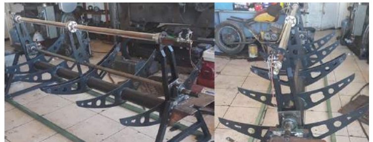
Imagen 21. Adaptación de componentes y barra Cold Rolled de ACERO REDONDO (1045) DE 1 1/2”.
