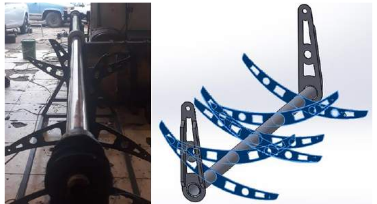
Imagen 8. Soportes de estructura, después de remover la soldadura.
