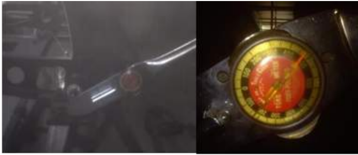
Imagen 15. Medición de torque en la entrada del eje de rotación. Medido en foot-pounds.
