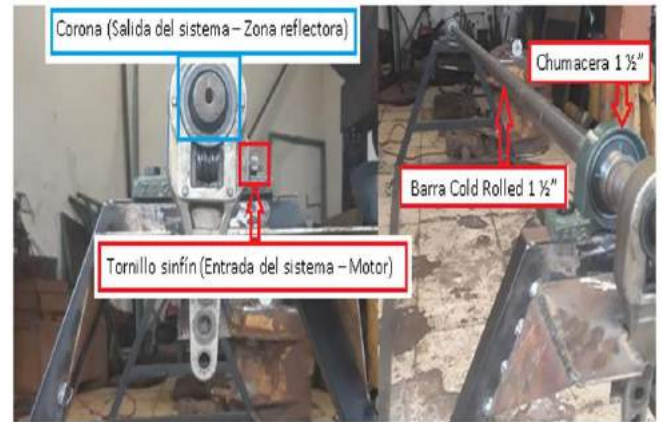
Imagen 20. Barra “Cold Rolled” y Tensor de Ajuste Manual adaptados a la estructura CCP.
