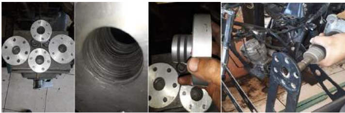
Imagen 13. Desensamble del tubo absorbente.
